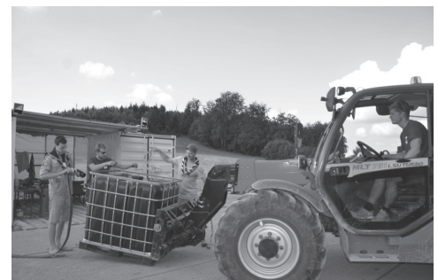
Mit dem Stapler werden die 1000 Liter Wasser gelupft. Foto: Beira
